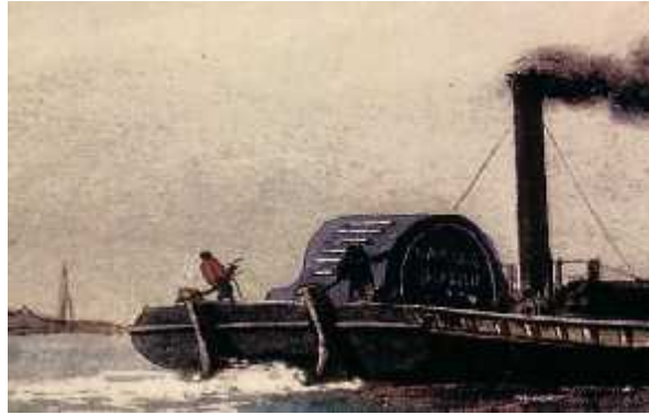
Fig.12 Dibujo de timón doble en propulsión por rueda de paletas a popa.
