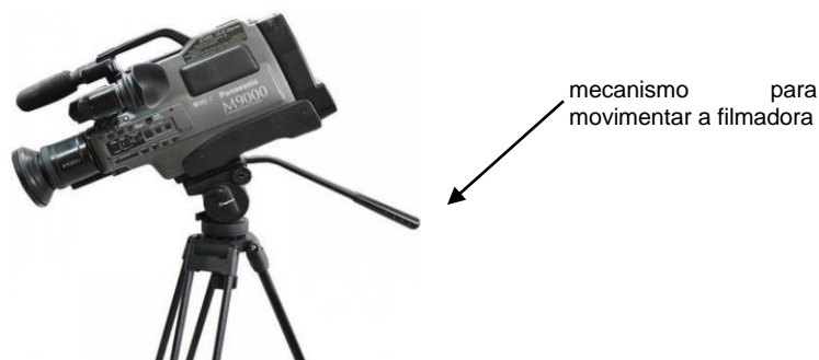
Figura 1 - Câmera no tripé e a seta mostra o mecanismo para movimentar a filmadora na coleta de dados.
