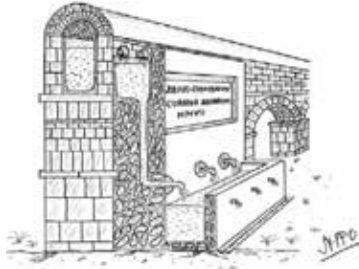
Ilustración 4. Fuente aliviadero típica romana
