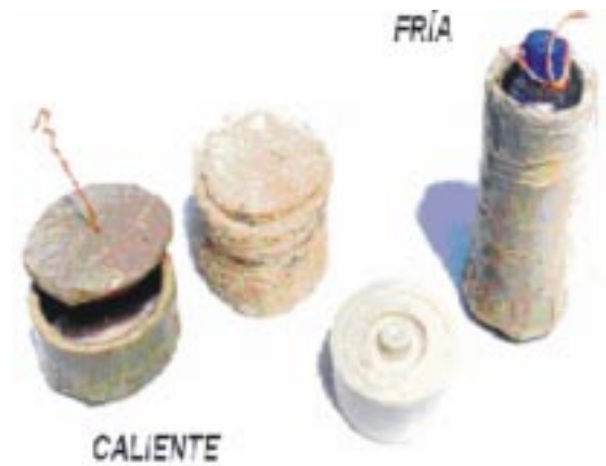
Figura 5. Probetas para el ensayo de vida térmica
