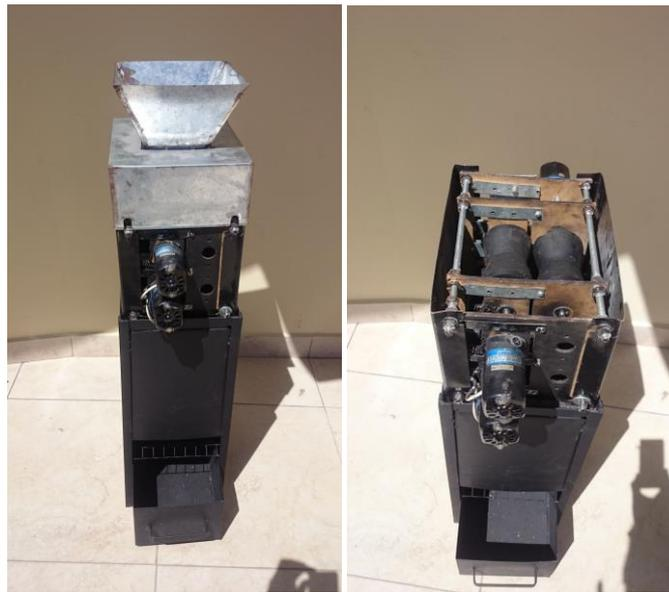
**Figura 14.** Prototipo desgranador de maíz.
