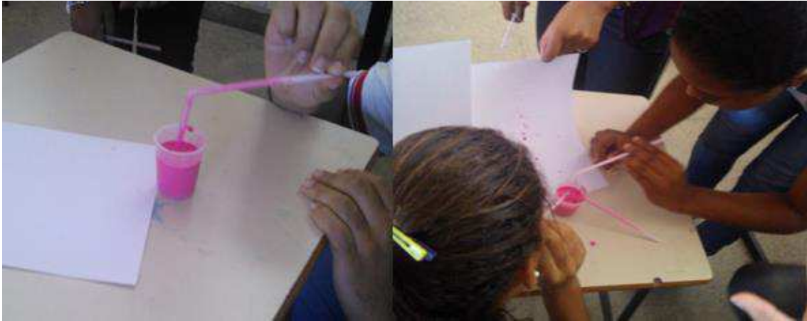
Fig. 3 – Construindo um pulverizador, comprovando o Efeito de Bernoulli.
