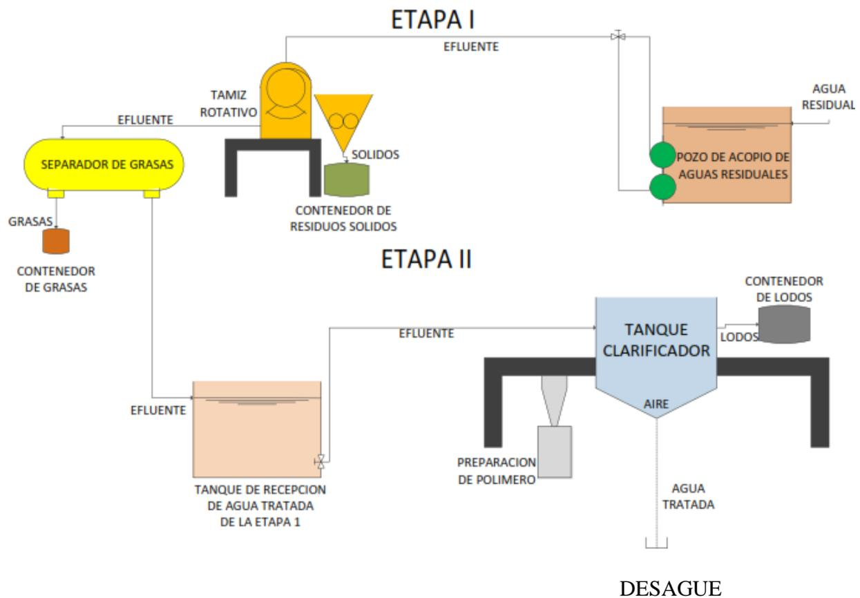
Ilustración 6 Diagrama PTAR para FISHCORP S.A.
