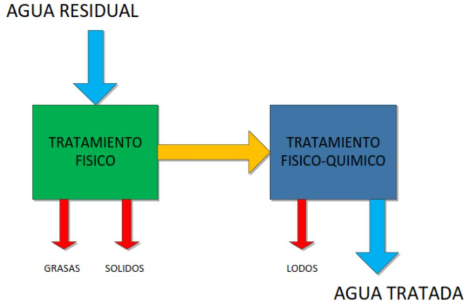
Ilustración 1 Diagrama General del Sistema de Tratamiento de Aguas Residuales para Fishcorp S.A.
