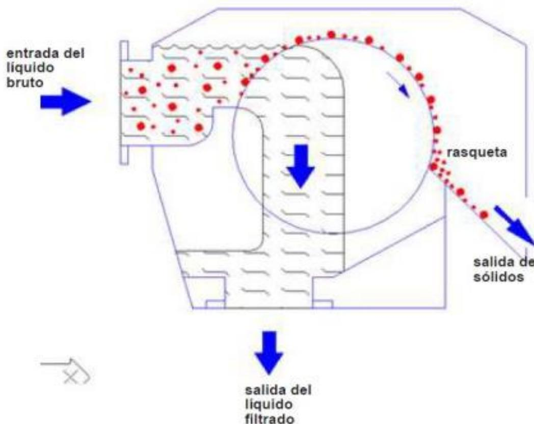
Ilustración 2 Representación gráfica del funcionamiento del tamiz rotativo
