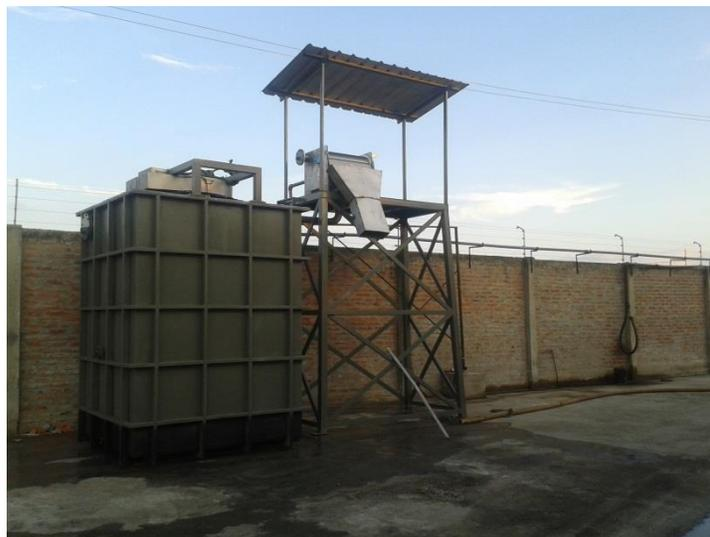
Ilustración 5 Tamiz Rotativo y Separador de Grasas de FISHCORP S.A.
