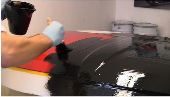
Figura 2: Aplicação de Gel-coat em molde aberto (EASYCOMPOSITES, 2016)
