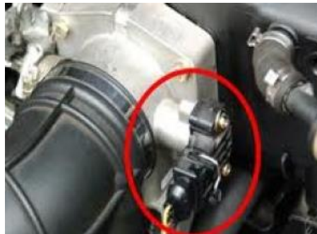
Figura 2. Sensor de posición del estrangulador
