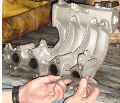
Figura 9. Toma de medidas del múltiple desmontado
