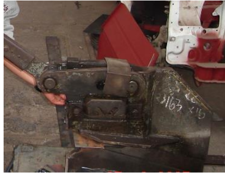
Figura 10. Corte de brida
