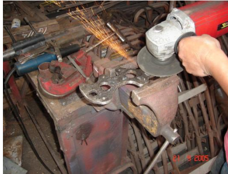
Figura 12. Pulido de la brida
