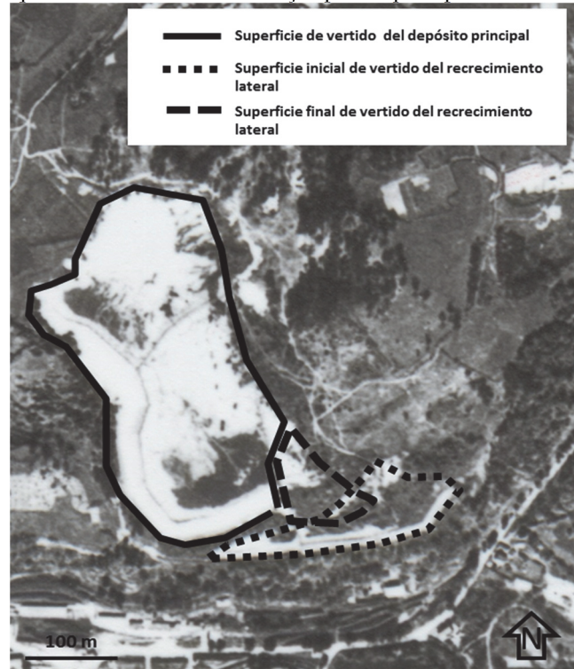
Figura 13. Comparación entre las superficies de vertido. Las superficies de las que se dispuso para realizar el vertido en el recrecimiento lateral resultaron muy reducidas en comparación con la superficie de vertido disponible para el depósito principal
