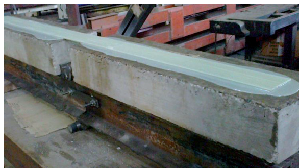
Figura 9. Sistema de anclaje a).
