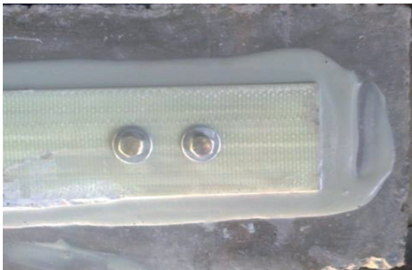
Figura 12. Sistema de anclaje c). 2 bulones 8.8.
