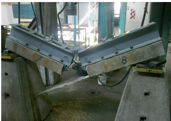
Figura 12. Sistema de anclaje c). 2 bulones 8.8.
