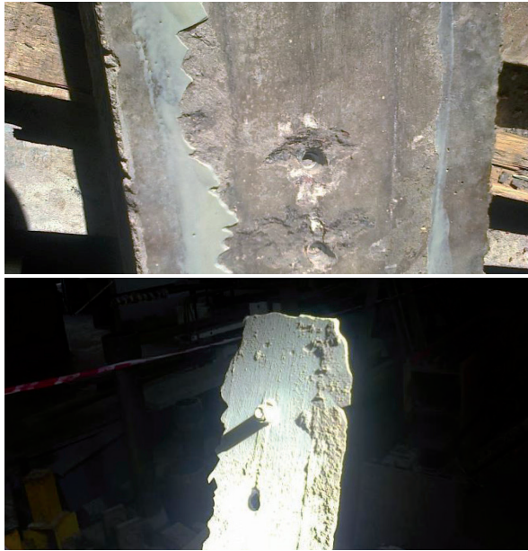
Figura 20. Ensayo n° 8 Lámina con dos bulones 8.8 en cada extremo.
