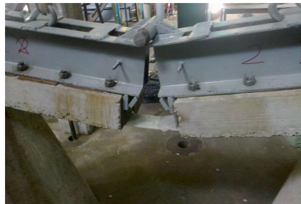
Figura 18. Ensayo n° 6 Lámina con dos bulones 8.8 en cada extremo.
