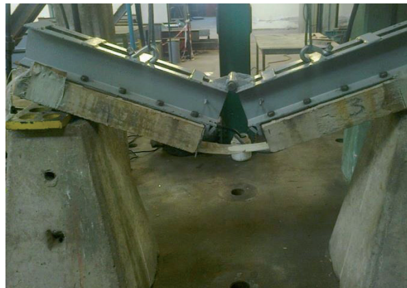
Figura 14. Ensayo n° 2, Lámina adherida sin refuerzos de anclaje.
