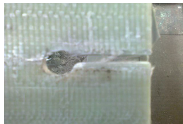
Figura 19. Ensayo n° 7 Lámina con un bulón 8.8 en cada extremo.
