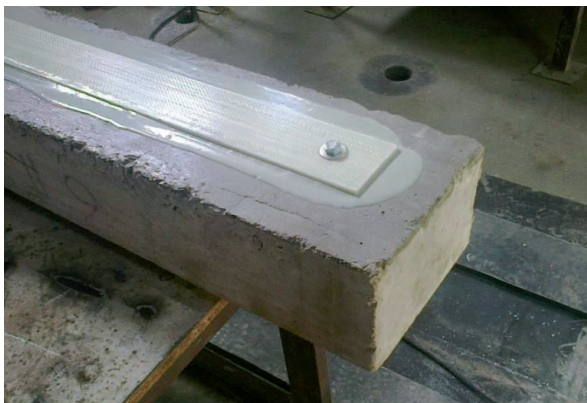
Figura 16. Evsayo n° 4 Lámina con refuerzos de telas en los extremos.
