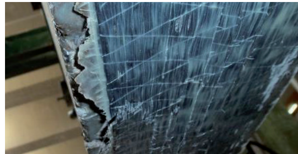
Figura 5. Rotura del refuerzo de fibras bajo carga puntual de viga V2.
