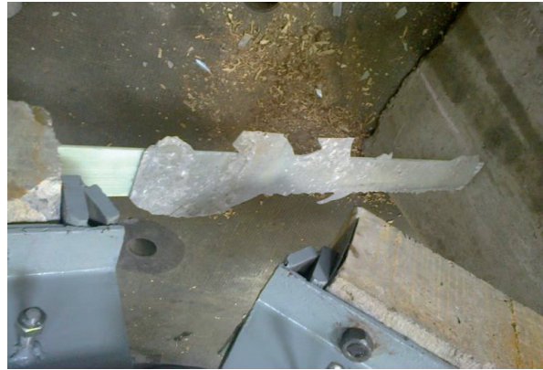
Figura 13. Ensayo n° 1, Lámina adherida sin refuerzos de anclaje.
