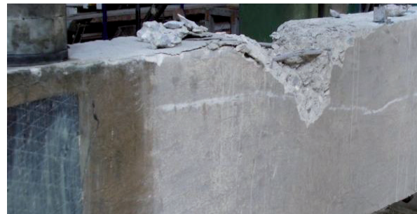
Figura 5. Rotura del refuerzo de fibras bajo carga puntual de viga V2.
