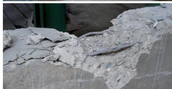
Figura 6. Falla por compresión del hormigón de viga V5 (refuerzo de fibras de vidrio intacto).
