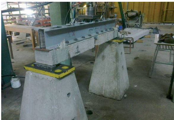
Figura 15. Ensayo n° 3 Lámina con refuerzos de telas en los extremos.
