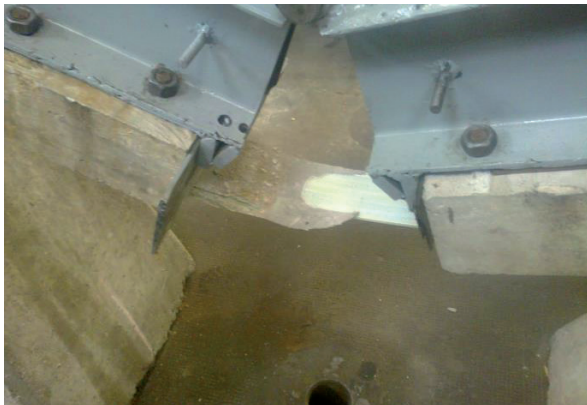
Figura 15. Ensayo n° 3 Lámina con refuerzos de telas en los extremos.
