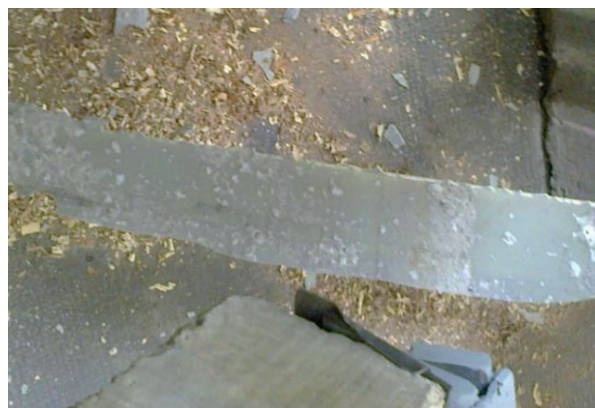
Figura 14. Ensayo n° 2, Lámina adherida sin refuerzos de anclaje.
