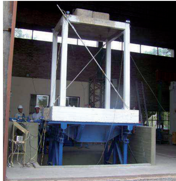
Figura 1. Pórtico de hormigón armado en la mesa vibradora de la Universidad Nacional de San Juan.
