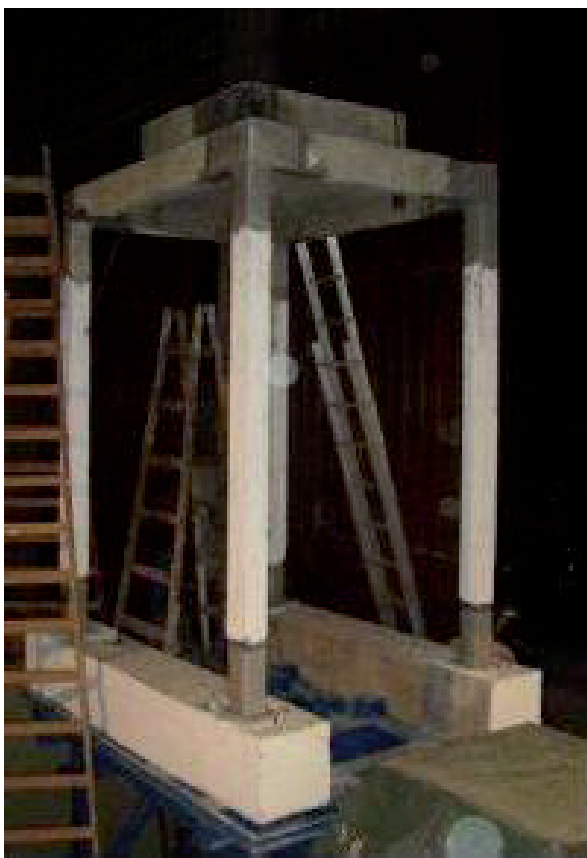
f) Pórtico reforzado.
