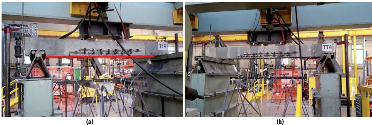
Figura 11. Aparato experimental para las pruebas de flexión (Prueba 4PB) (a) un viga reforzada en términos de resistencia a la flexión (b) una viga reforzada en términos de resistencia al cizallamiento.
