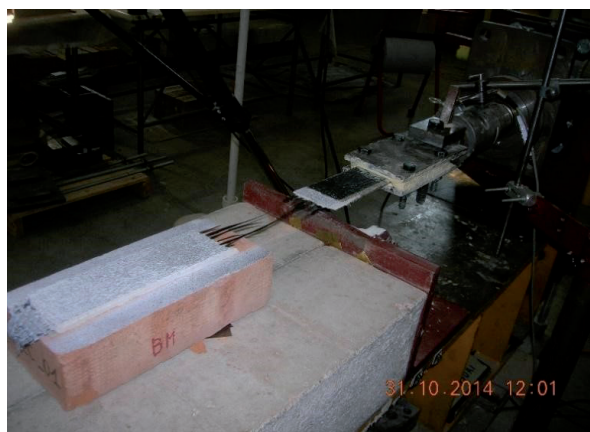
Figura 18. Prueba de resistencia al cizallamiento del FRCM basado en mortero de cal y fibra de carbono unidireccional, usando el promotor de adhesión IPN, la ruptura de la fibra de carbón es claramente evidenciada (8).
