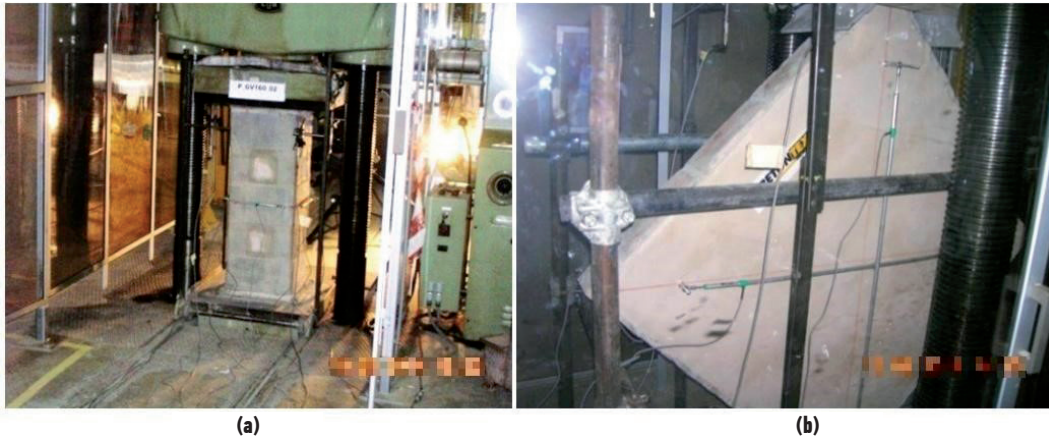
Figura 10. Pruebas de laboratorio de columnas y paredes de ladrillo, reforzadas con la tecnología FRCM usando resinas a base acuosa IPN y mortero de cal (Universidad de Bolonia- Departamento CIRI).
