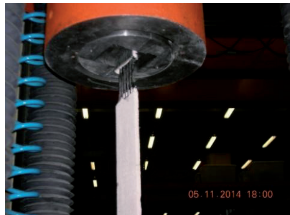
Figura 17. Ensayo de tracción de la muestra de cal FRCM sin el promotor de adhesión de las fibras, el deslizamiento de las fibras comienza antes de la formación de grietas.
