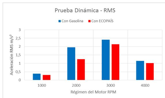
**Figura 7.** Efectos del combustible ecopaís y gasolina extra, en la aceleración RMS (prueba dinámica – gráfico 1).
