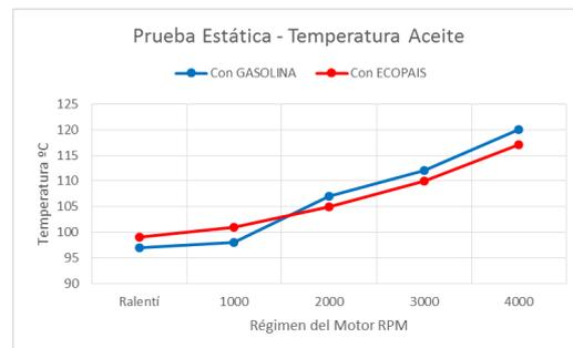
**Figura 2.** Efectos del combustible *ecopaís* y gasolina extra, en la temperatura del aceite (prueba estática – gráfico 2).
