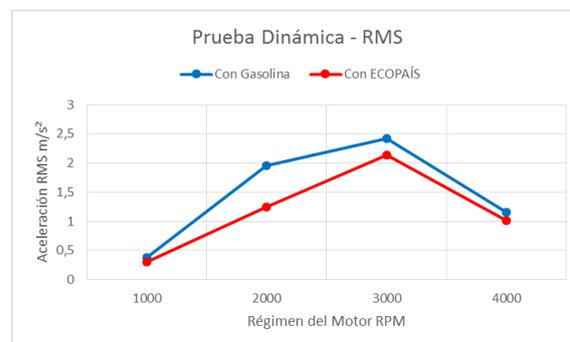
**Figura 8.** Efectos del combustible ecopaís y gasolina extra, en la aceleración RMS (prueba dinámica – gráfico 2).
