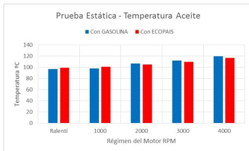
**Figura 1.** Efectos del combustible *ecopaís* y gasolina extra, en la temperatura del aceite (prueba estática – gráfico 1).
