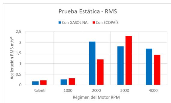
**Figura 5.** Efectos del combustible ecopaís y gasolina extra, en la aceleración *RMS* (prueba estática – gráfico 1).
