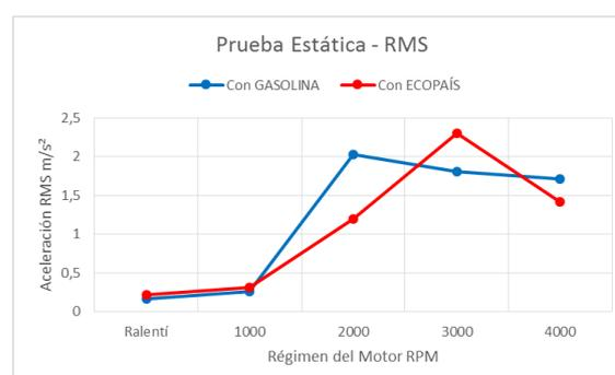
**Figura 6.** Efectos del combustible ecopaís y gasolina extra, en la aceleración *RMS* (prueba estática – gráfico 2).
