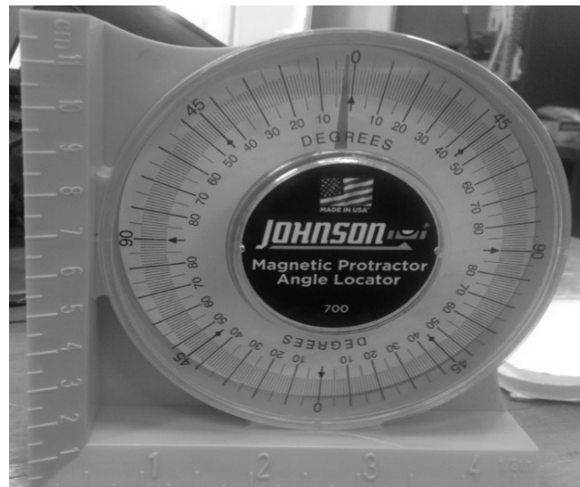
Figura 5. Inclinómetro Johnson "Magnetic Protractor Angle Locator". Fuente: Los Autores.
