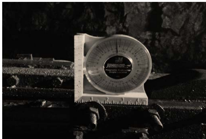
Figura 6. Inclinómetro colocado en brazo del Jumbo DD-321. Fuente: Los Autores.
