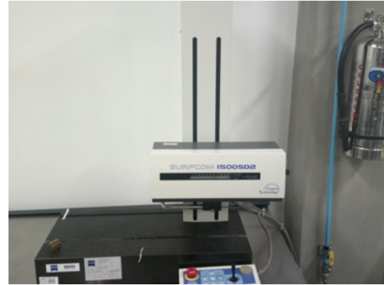
Figura 4. Rugosímetro CARL ZEISS modelo SURFCOM 1500SD2.
