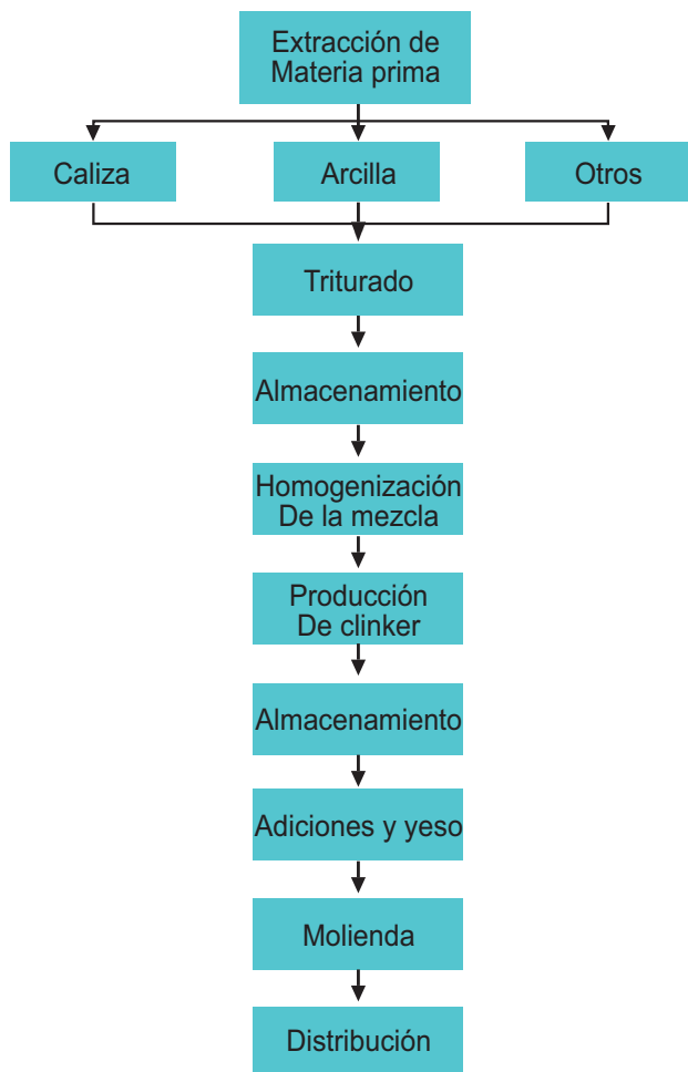
Figura 1. Proceso esquemático de la producción de cemento portland Fuente: Los autores
