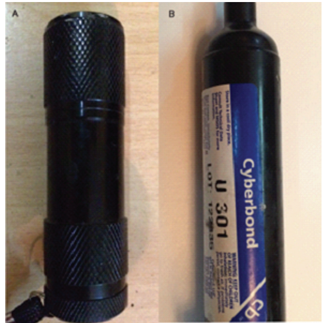
Fig. 1. A. Fuente de luz ultravioleta mediante un dispositivo en forma de lapicera de 1,5 cm de diámetro (linterna de luz negra de 9 LED 1 Modo UV). B. Tubo de cianometacrilato.
