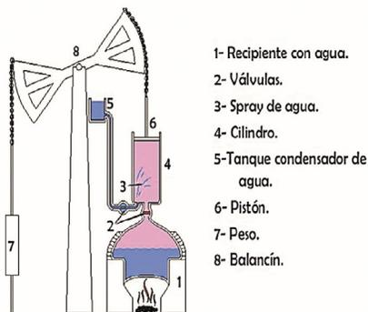
Figura 5. Máquina de Newcomen con sus partes señaladas.
