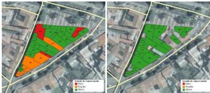
**Figura 4.** A la izquierda: estado de conservación de las edificaciones antes de la Campaña de Mantenimiento. A la derecha: estado de conservación después de la Campaña. Achig et al. (2016)
