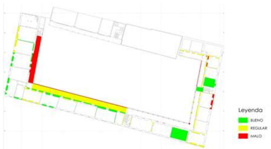
**Figura 6.** Estado de conservación de los elementos arquitectónicos en Planta Alta. Antigua Escuela San José. Fuente: Bermeo et al, 2016
