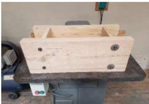
**Figura 5:** Tapialera utilizada para ensayos, Ecuador. Fuente: Propia
