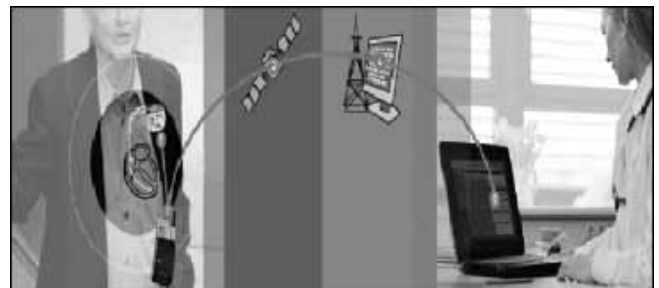
Figura 1. Sistema de seguimiento: el dispositivo emite información al transmisor que emite un SMS vía satélite a un centro de análisis que genera un informe accesible en el ordenador de la consulta.
