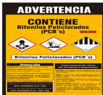
Figura 8.- Etiquetas de advertencia para los transformadores con contenido de PCBs
