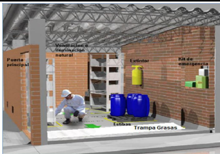
Figura 9.- Modelo una bodega con materiales de características retardantes al fuego, en especial la estructura que soporta el techo
