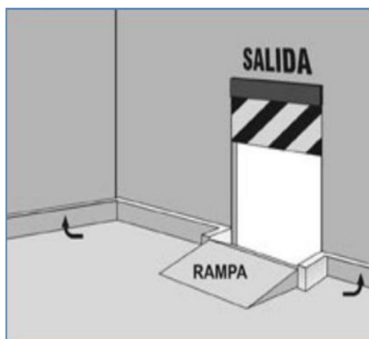
Figura 11.- Rampa inclinada con un alto no menor de 10 cm, con una pendiente no mayor al 10% para facilitar el acceso de los vehículos
