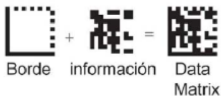
Figura N° 3.- Estructura de un Datamatrix (Sivart, 2017).
