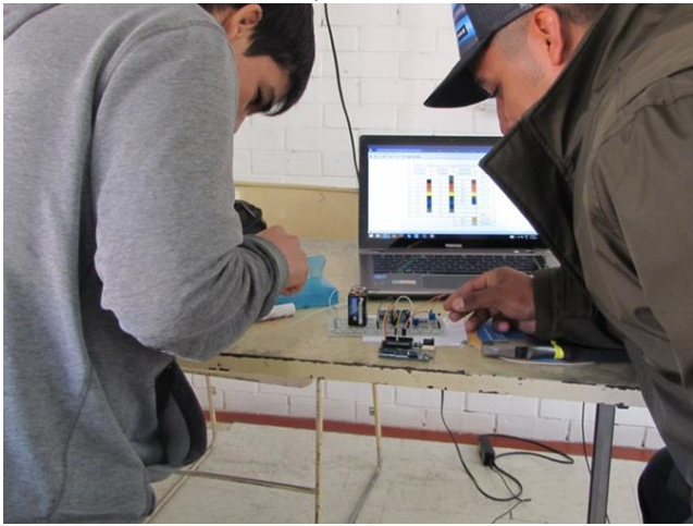
FIGURA 2. Alumnos realizando la calibración del circuito amplificador.
