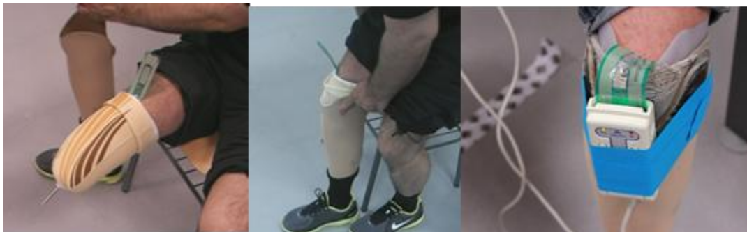
Figura 4: Silicona con sensor en cara anterior, colocación de la prótesis y caja de conexión
