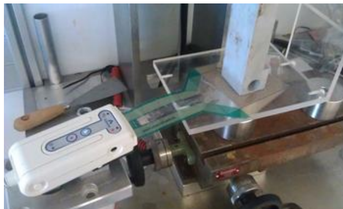
Figura 1: Calibrado del sensor de medición de presiones
