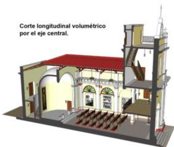
Figura 19 – Corte longitudinal volumétrico por el eje central del templo. Fuente: Archivo del autor.
