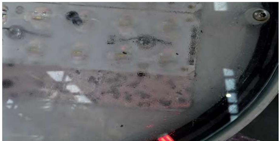
MÓDULO ÓPTICO CON CONDENSACIÓN INTERNA
