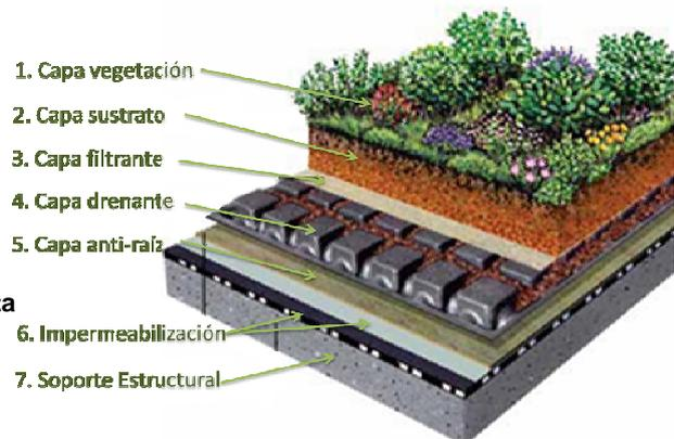
Fig.7. Elementos que componen una cubierta naturada. Fuente:( Zinco, 2015)
