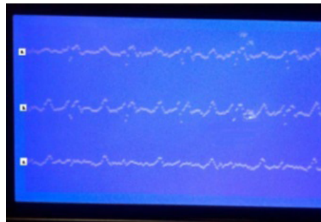
Figura 20. Visualización de las señales ECG en la GLCD.
