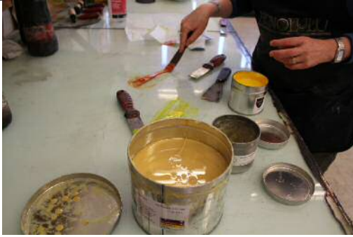
Fig. 15. Mezcla de la tinta de color con la base transparente
