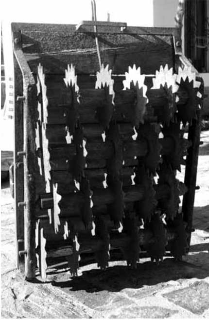
A la izquierda, detalle de los rodillos y cuchillas del rulo (Cortesía de Juan C. Salazar) y a la derecha rulo situado en la Puerta de la Hoya.
