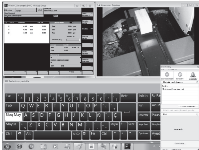
Figura 4. Acceso remoto al software de la máquina utilizando un software VNC libre.
