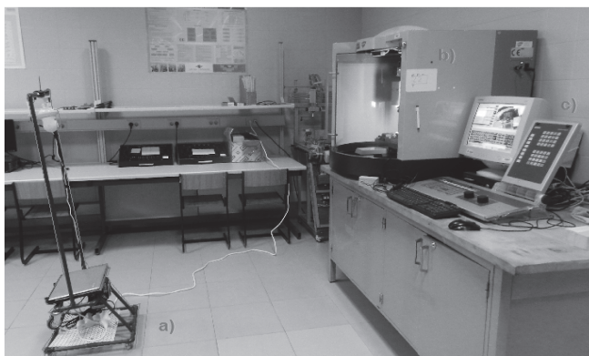
Figura 6: Laboratorio H1. Contiene adicional al remoto la estructura a) AVATAR_a que brinda servicios adicionales a la estación de Laboratorio remoto. b). La máquina tele-operada y c) El equipo de control. Fuente: Los autores
