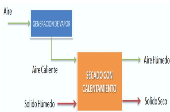
Fig.1.Diagrama de flujo para el funcionamiento del secador de bandeja Edibon, Modelo SBAN
