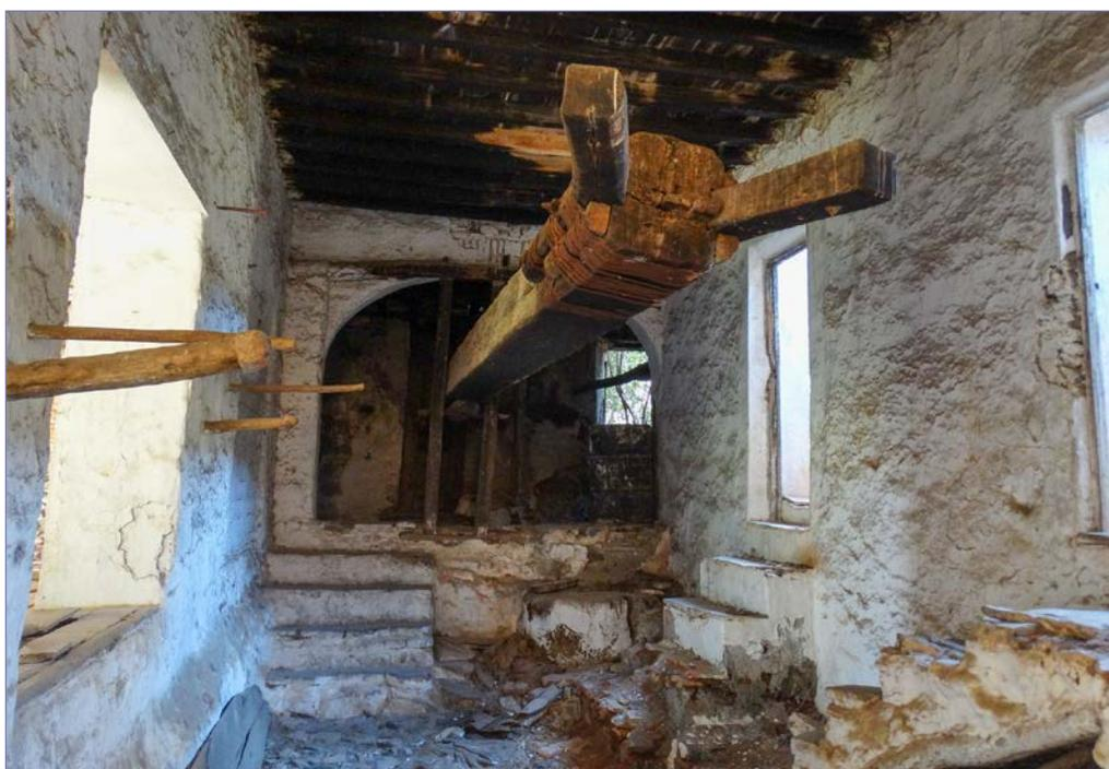
**Fig. 15.** Prensa de viga y husillo en lagar de Lo Rute, Vuelta Grande, Málaga
