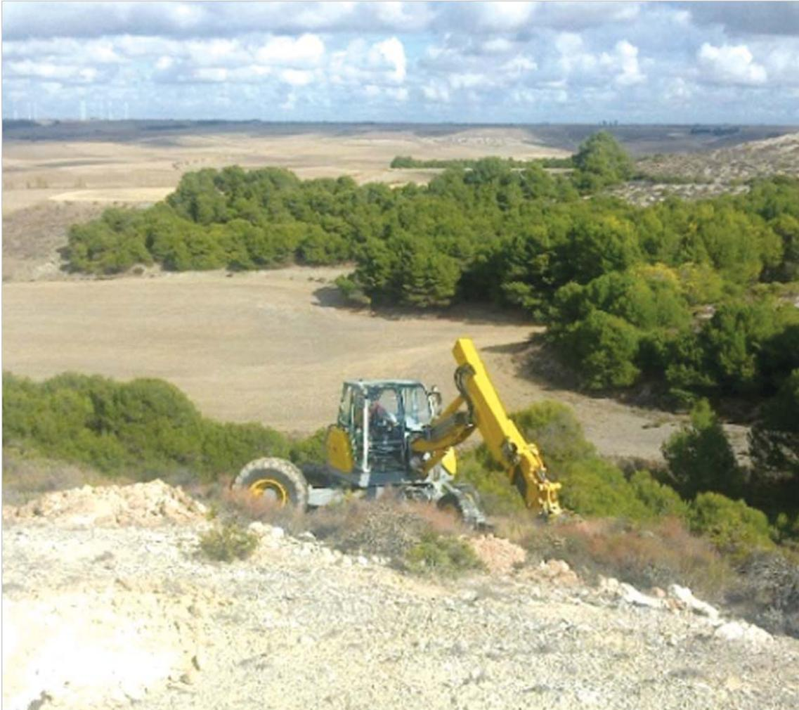
**Figura 10.** El uso de la retroaraña permite la elaboración de microcuencas individuales para las repoblaciones en terrenos con orografía complicada (Valladolid).
