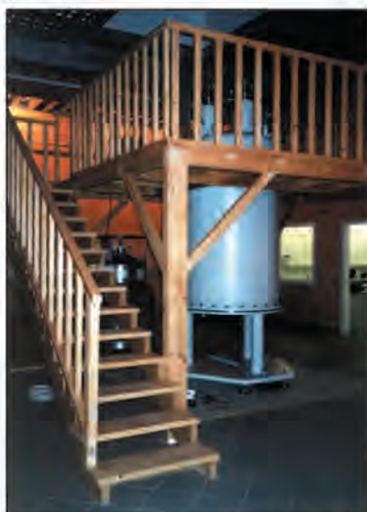
Figura 5. Imán superconductor del instrumento de 800 MHz situado en el Parque Científico de Barcelona. Mientras que los imanes superconductores de instrumentos de campo más bajo trabajan a la temperatura de ebullición del helio líquido (4 K), en este caso la temperatura de trabajo es 2 K. Esta temperatura tan baja se consigue enfriando el helio líquido en el interior del imán por efecto Joule-Thomson.
