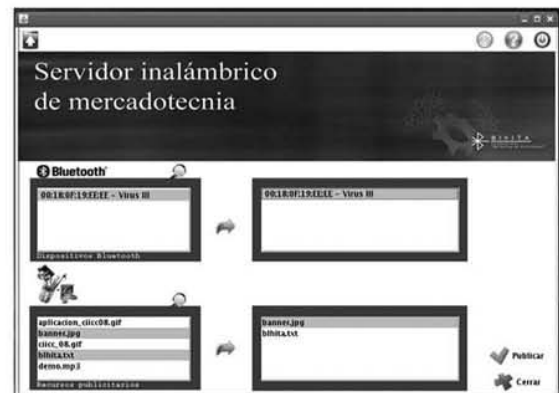
Figura 8. Detección y filtrado de dispositivos móviles y recursos a publicar.
