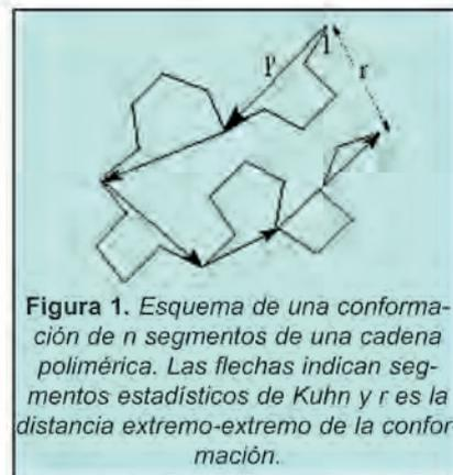
Figura 1. Esquema de una conformación de  $n$  segmentos de una cadena polimérica. Las flechas indican segmentos estadísticos de Kuhn y  $r$  es la distancia extremo-extremo de la conformación.
