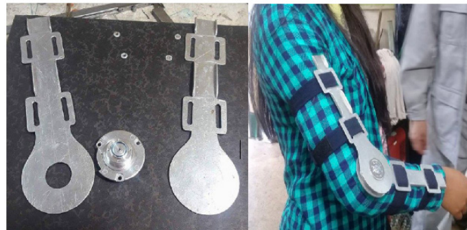
Gráfico 3. Partes de la órtesis en láminas de Aluminio & Ensamble.
