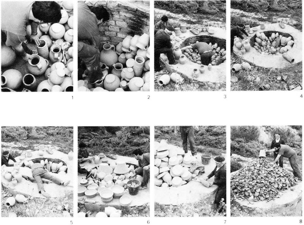
CARGA DEL HORNO: 1-5. Encañado, 6-8. Colocación de los catadores y formación del copete.
