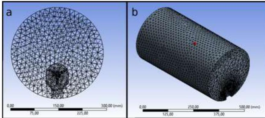
**Fig. 4.** Ejemplo de la malla utilizada para la simulación CFD. **a.** Vista frontal. **b.** Proyección isométrica. *Fuente: elaboración propia.*
