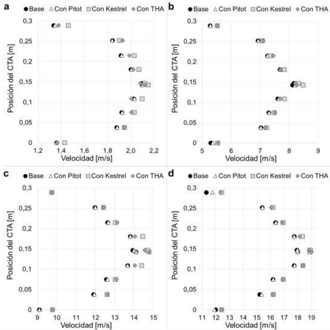
**Fig. 8.** Perfiles de velocidad del CTA en ausencia y presencia de los MUT. Cada panel corresponde a una velocidad nominal diferente. **a.** 2 m/s. **b.** 8 m/s. **c.** 14 m/s. **d.** 18 m/s. Fuente: elaboración propia.
