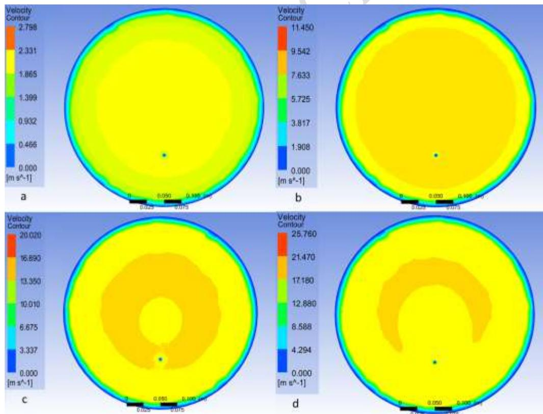
**Fig. 5.** Contornos de velocidad en presencia del tubo de Pitot tipo L. Cada panel corresponde a una velocidad nominal diferente. **a.** 2 m/s. **b.** 8 m/s. **c.** 14 m/s. **d.** 18 m/s. *Fuente: elaboración propia.*
