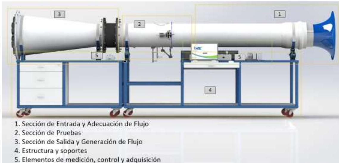
**Fig. 1.** Secciones del túnel de viento WSL20. Fuente: documentación interna del túnel WSL20, CDT de Gas.
