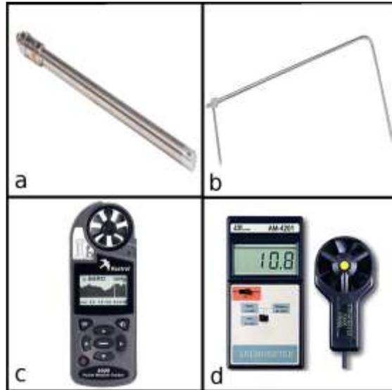
**Fig. 3.** Medidores utilizados. **a.** CTA. **b.** Tubo de Pitot. **c.** Kestrel 4000. **d.** THA. Fuente: catálogos de anemómetros [22 - 25].
