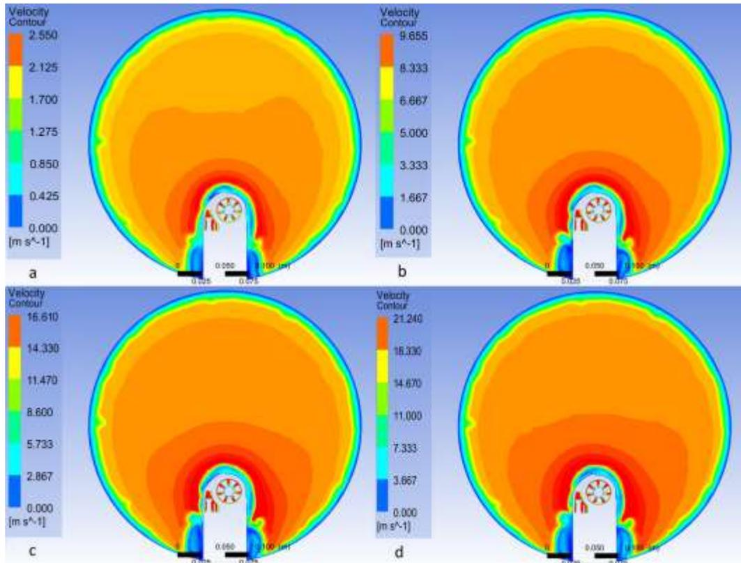
**Fig. 6.** Contornos de velocidad en presencia del Kestrel. Cada panel corresponde a una velocidad nominal diferente. **a.** 2 m/s. **b.** 8 m/s. **c.** 14 m/s. **d.** 18 m/s. Fuente: elaboración propia.
