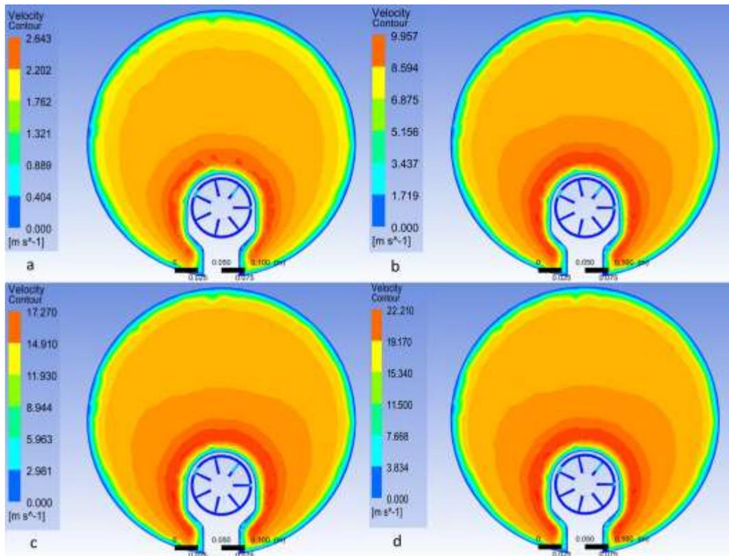
**Fig. 7.** Contornos de velocidad en presencia del THA. Cada panel corresponde a una velocidad nominal diferente. a. 2 m/s. b. 8 m/s. c. 14 m/s. d. 18 m/s. Fuente: elaboración propia.
