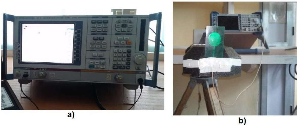
Figura 11 Configuración experimental implementada para estimación del parámetro S_{11} . a) Analizador Vectorial de Redes ZVB 20 b) Conexión con la antena.
