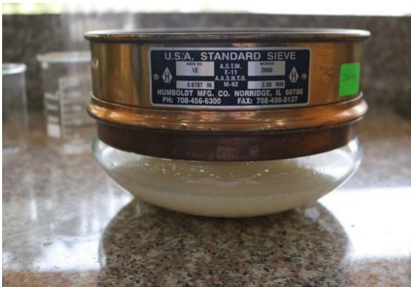
Figura N° 1.- Tamiz número 10 Mesh US Standard Sieves Series
