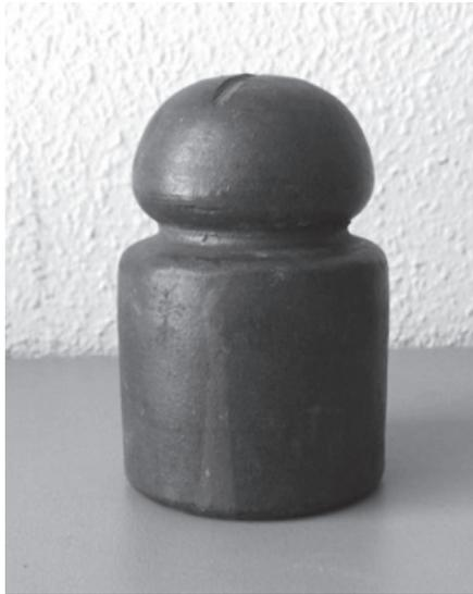
Figura 12. Cilindro de vidrio, recubierto de una caperuza de madera impermeabilizada.
