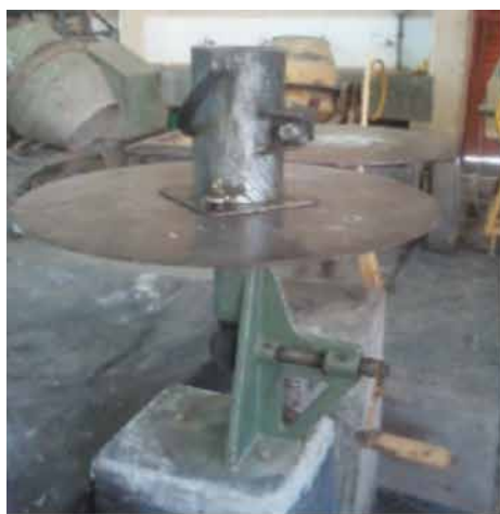
Figura 2. Adensamento dos corpos de prova. Em (a) podemos visualizar um corpo de prova sendo adensado na mesa de consistência e em (b) tem-se o gráfico que relaciona a massa unitária com o número de golpes por camada Fonte: Elaboração própria
