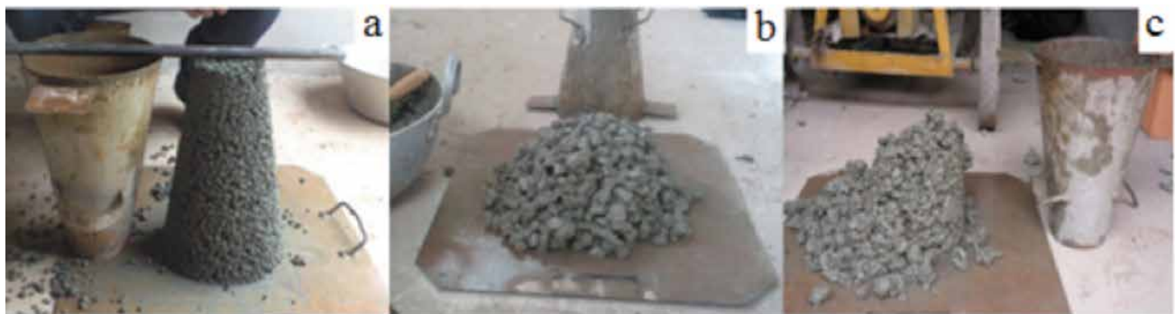
Figura 1. Ensaio do Slump no CoPe com agregado (a) B0, (b) B1 e (c) 50B0/50B1 Fonte: Elaboração própria
