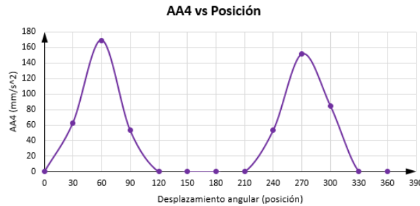
Fig. 15 Diagrama de aceleración del seguidor vs desplazamiento angular de la leva.
