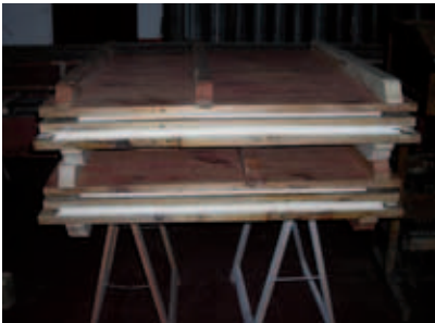
Fuelle (izquierda) y tubos restaurados (fragmentos de madera clara) (derecha).
