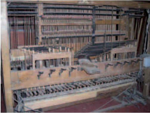
Vista frontal interna de la parte inferior de la consola, donde se aprecia todo el mecanismo y los enganches del pedal y el de expresión.
