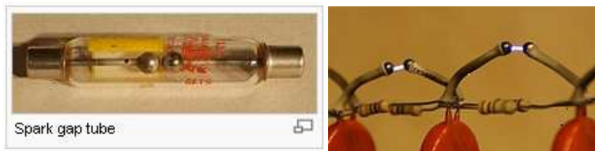
Figura 5: Explosor de esferas o Spark gap y banco de Marx construido con ellos, mostrando el momento en que salta el arco.
