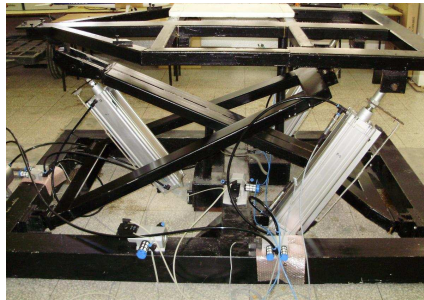
Figura 1. Plataforma neumática de estructura paralela fabricada por la empresa SIMPRO.
